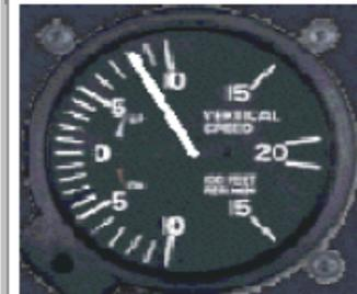
**ATTENTION**, cet instrument possédant un retard à l'indication ne doit pas être considéré comme un instrument de pilotage mais seulement comme un instrument de tendance ( le maintien d'altitude en vol en palier doit être vérifiée à l'altimètre et non au variomètre)
