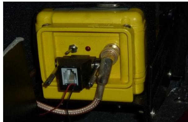
Boîtier émetteur ME 406 avec les liaisons au buzzer et à l'antenne
