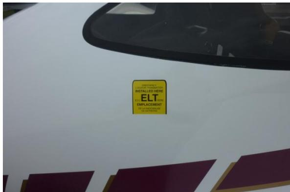
Etiquette indiquant l'emplacement de la balise à l'intérieur du fuselage
