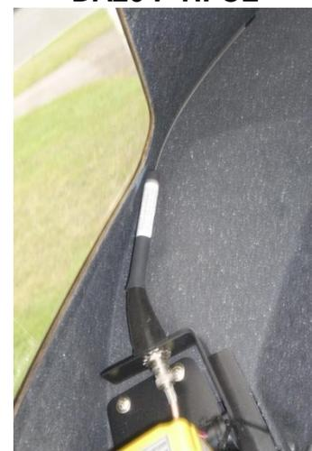
Fouet bi fréquence externe au boîtier et situés tous les deux dans l'habitacle, derrière le siège du passager
